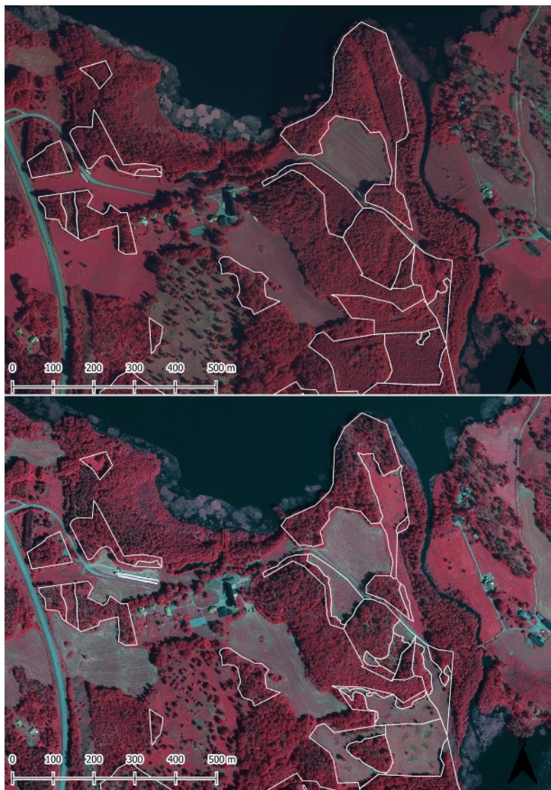
Figur 1. Indelning av området Åtvidsnäs före och efter åtgärd visualiserad mot flygbild i infrarött. Området har delats in i mindre delar baserat på krontäckningsgraden efter utförda restaureringsåtgärder jämfört med den indelning som gjordes före åtgärd eftersom variationen i täckningsgrad har ökat.
